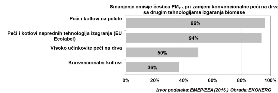
Sl. 6-13: Smanjenje emisije pri zamjeni konvencionalne peći na drva s drugim tehnologijama izgaranja biomase
